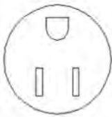
D-100 120 Volt 15 Amps Nema 5-15R Receptacle
